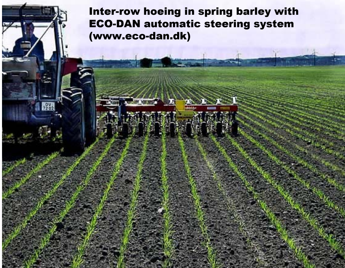
Figure 2. Inter-row hoeing in organic cereals (50 cm row spacing) with an automatic steering system. The yellow box on the hoe frame contains two cameras for row detection. (Binage inter-rang à guidage automatique en céréales organiques. La boîte jaune contient 2 caméras permettant la détection des rangs).
