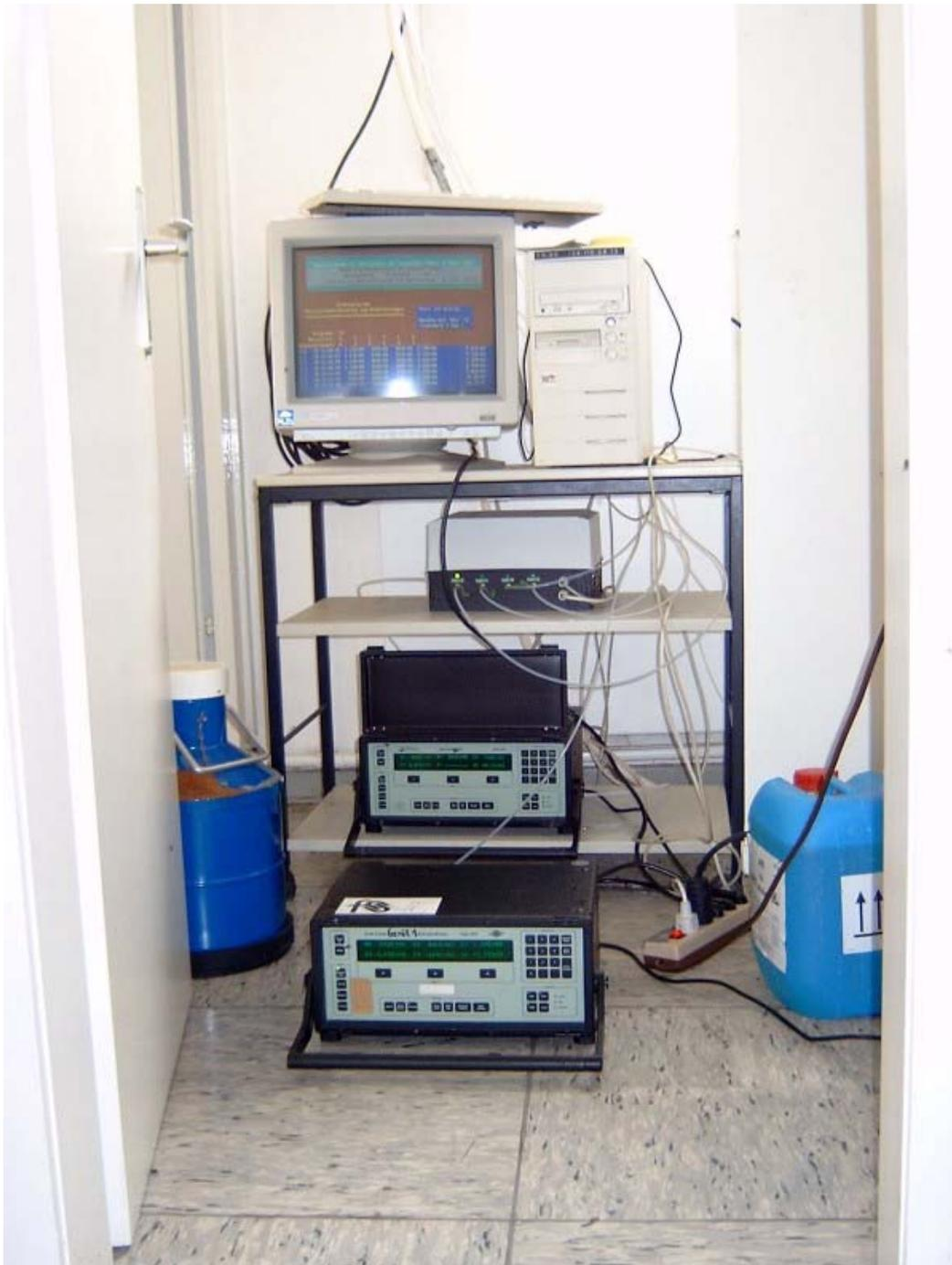
Abbildung 10: Multigasmonitor zur Schadgasmessung mit Messstellenumschalter und PC
