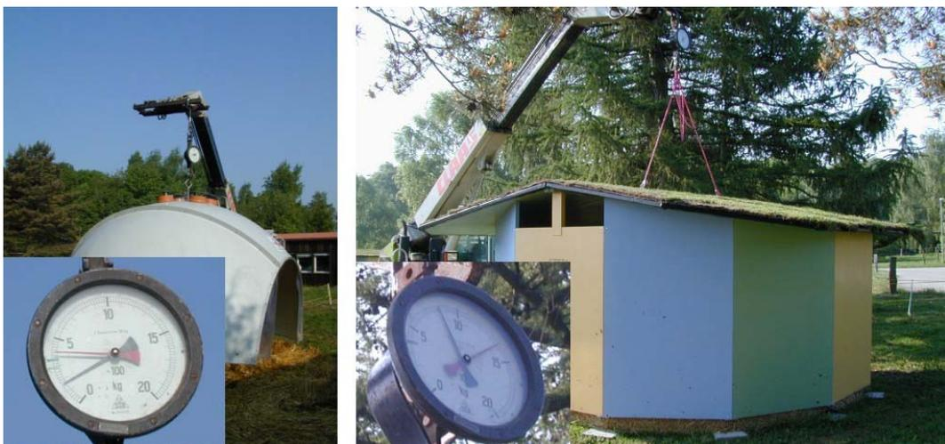
Abbildung 15: Gewichtsbestimmung mit einer Zugwaage für beide Großraumhütten
