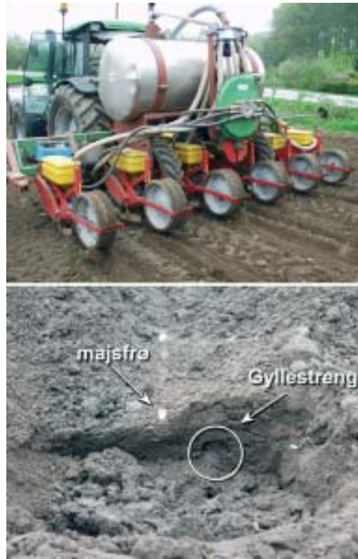
Maskine udviklet til såning af majs samtidig med, at der placeres gylle. På det nederste billede ses gyllestrengens placering i forhold til majsfrøet. Maskinen er udviklet af Hans Jørgen Hansen.
