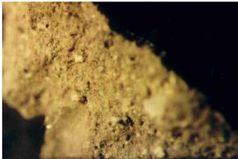
Abb. 1: Verdichtetes Bodenaggregat (Lehm) 3 mm, 20-fach vergrößert: betonartig, ohne Poren.
