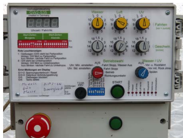
Abb. 63: Die Gießwagensteuerung wurde um ein Luftmodul erweitert. Pro Start werden mit der gezeigten Einstellung 10 Fahrten (hin und zurück) bei einer Geschwindigkeit von 10 m/min durchgeführt.
