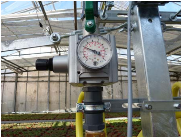
Abb. 62: Mit einem Betriebsdruck von 2,5 - 3 bar konnten Luftgeschwindigkeiten von 6 - 8 m/s für die Reizbehandlung realisiert werden.
