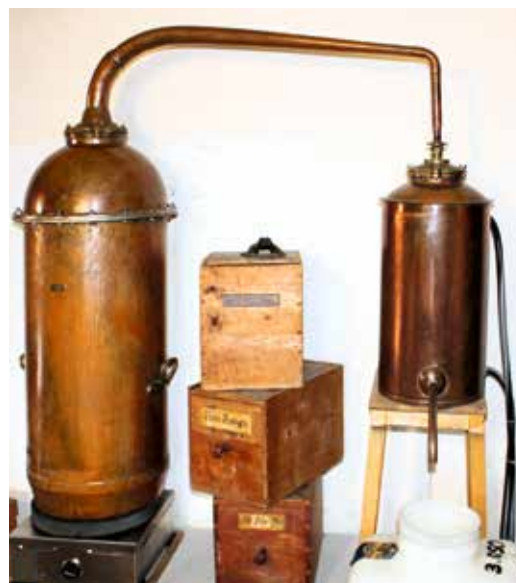
Einer von den zwei Brennapparaten von Philippe Martin, mit denen er rund 9000 Liter Absinth jährlich herstellt.
