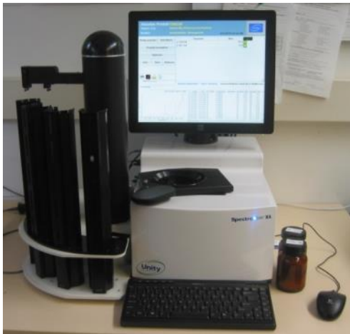
Abb. 24: Anordnung zur Messung der NIR-Spektren im Futtermittellabor Grub mit automatischer Probeneinspeise-Einheit (links)
