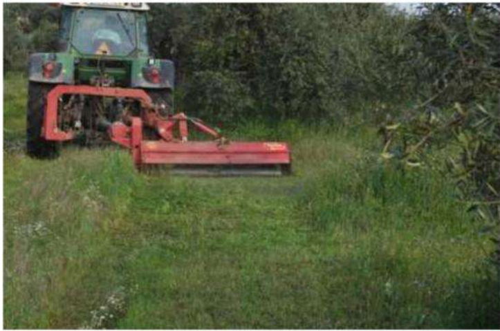
Εικόνα 2-6 Κούρεμα της πρασινάδας (φυτεμένη + αυτοφυή), και άλεσμα των κλαδεμένων φυλλωμάτων, με ένα μηχανήμα με λεπίδες
