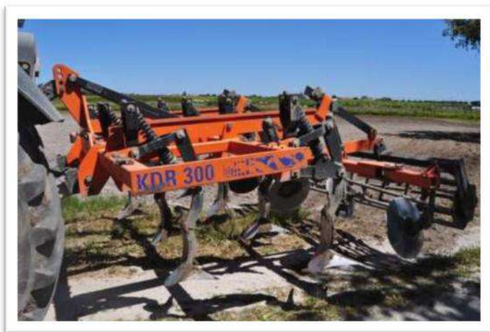
Εικόνα 2-2 Σκαπτικό μηχανήμα για σκάψιμο του εδάφους με λιγότερα περάσματα και λιγότερη κατανάλωση καυσίμου και ενέργειας
