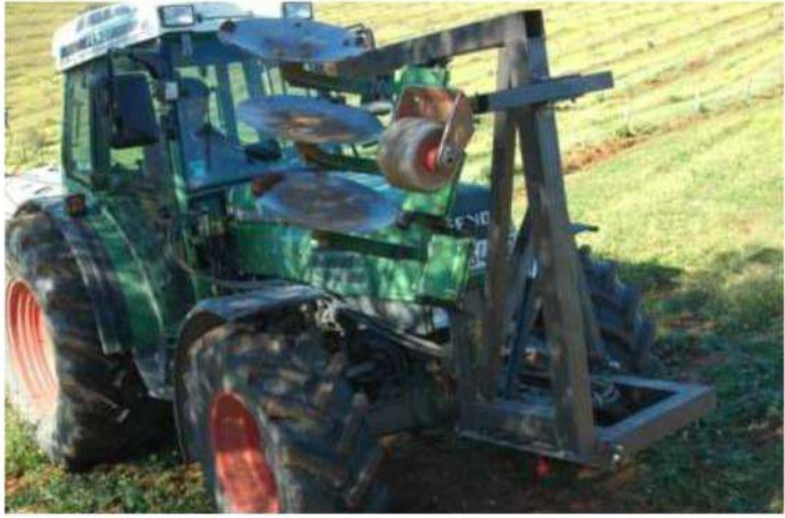
Görsel 2 5 Nakliye pozisyonunda diskli tırmık makinesi, sandviç metodu ile sıra üzerinde toprak işleme amacıyla kullanılı
