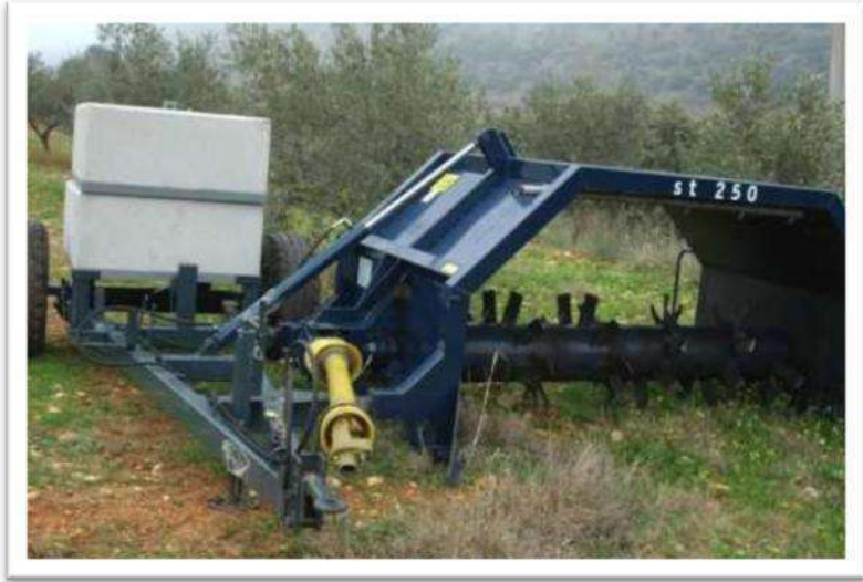
Görsel 2 9 Kompost yığınını döndürme ve havalandırma için kullanılan makina
