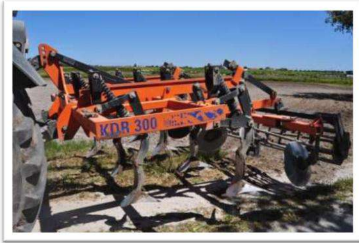
Görsel 2 2 Daha az yakıt ve enerji tüketimiyle toprağı hazırlamak için kullanılan kombine makine
