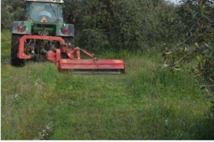
Görsel 2 6 Çekiş tipi ot biçme makinesi ile çim biçme, ögütme ve yaprak budama
