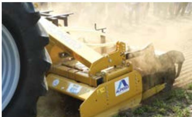
Une herse rotative équipée de dents spéciales permet de détruire une luzernière en un seul passage, au prix d'un grand besoin en puissance. *Photo: hir*
