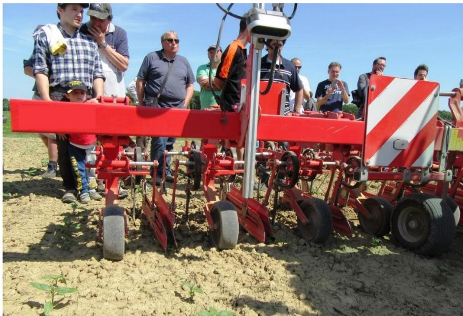
Foto 2: Sarchiatrice con guida assistita da videocamera su girasole. Data: 21-05-2016 (Foto Gemini Delle Vedove)
