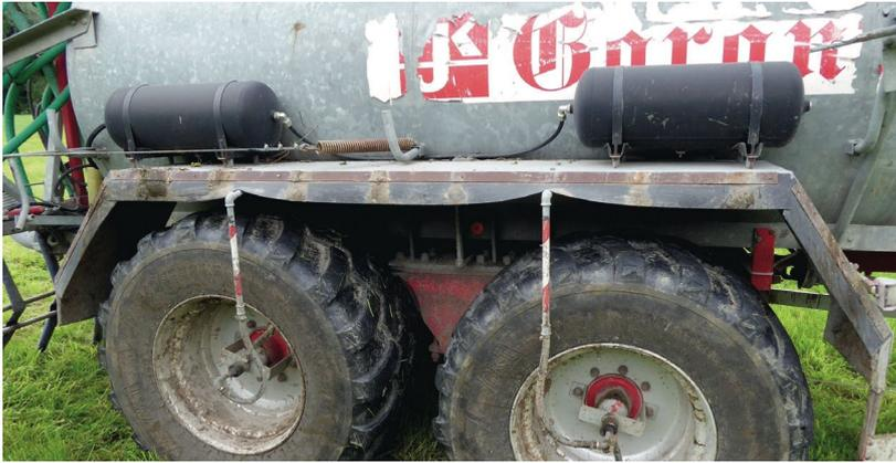
Gerade bodennah ausbringende Güllefässer sind schwer und haben hohen Achslasten. Neben der Bauweise mit mehreren Achsen kann der Schaden an Boden und Grasnarbe auch durch automatische Reifendruckabsenk-Systeme reduziert werden.
