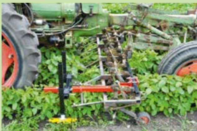
Forrás: Klaus Wilbois – Lúdtalpkapákkal, töltögetőtárcsákkal és Kress-féle ujjas kapával felszerelt kultivátor
