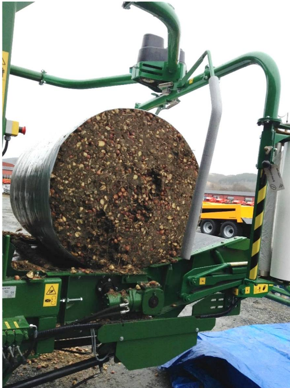
Bilde 2. 1.100 kg frasorterte hakkede poteter fra Produsentpakkeriet, 150 kg grassurfôr og 180 kg betefiber ble ensilert i en rundball ved hjelp av en Orkel Compactor MP2000 (foto: Adler, S., NIBIO).
