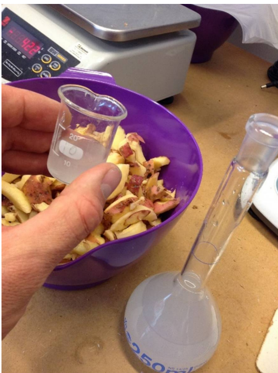
Bilde 11 og 12. 10 mL av en preparert stamløsning med bakterier blandes med de andre ingrediensene. Antall kolonidannende L. plantarum ble målt på agarplater (MRS, Man Rogosa Sharp) for å beregne preparering av stamløsningene (foto: Adler, S., NIBIO).
