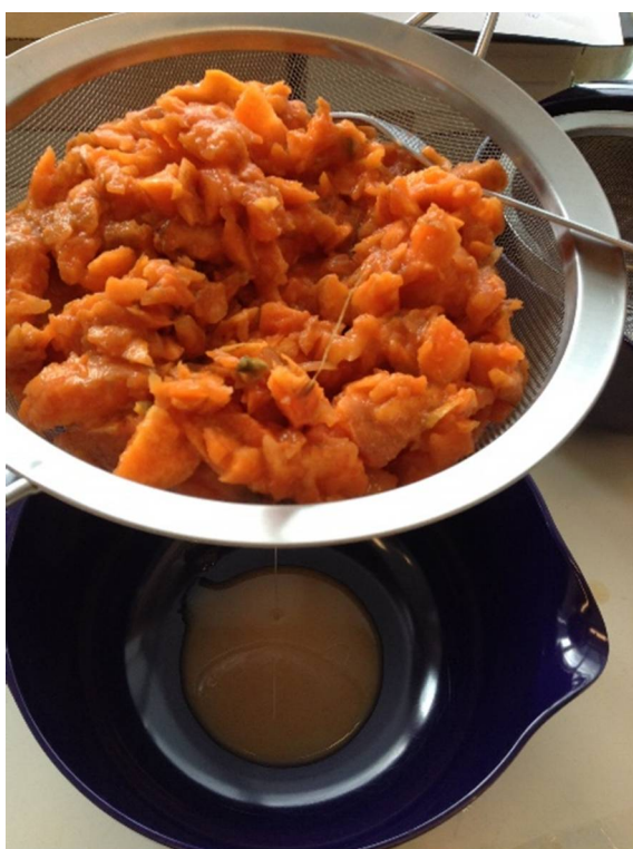
Bilde 15 og 16. Etter separasjon av væske og restfraksjon ved hjelp av kjøkkensil ble prøver av begge fraksjonene tørket for å bestemme tørrstofftapet ved avrenning (foto: Adler, S., NIBIO).
