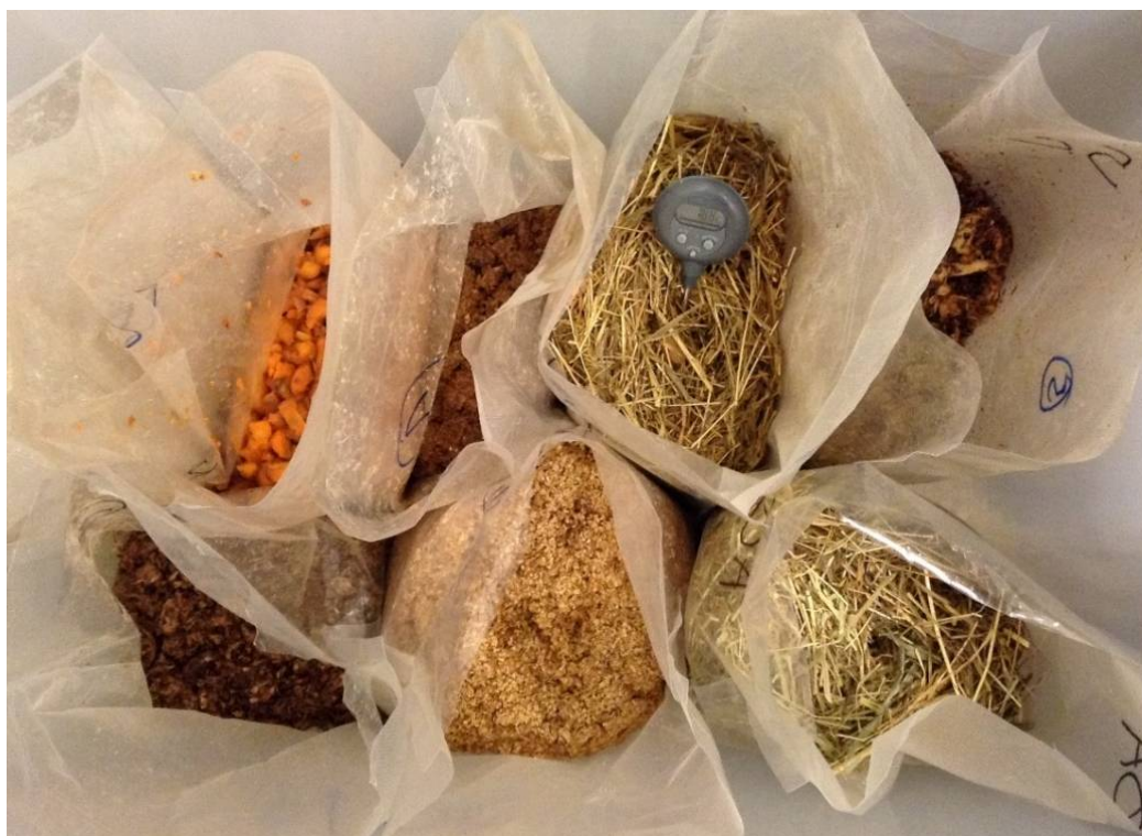
Bilde 17. Etter at posene ble åpnet og eventuell væske fjernet, ble gjentakene blandet og lagret ved romtemperatur. Temperaturen ble loggført to ganger om dagen over tre uker for å dokumentere aerob stabilitet, forsøk 1 (foto: Adler, S., NIBIO).
