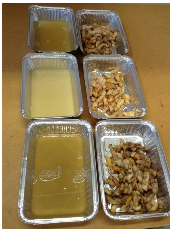
Bilde 15 og 16. Etter separasjon av væske og restfraksjon ved hjelp av kjøkkensil ble prøver av begge fraksjonene tørket for å bestemme tørrstofftapet ved avrenning (foto: Adler, S., NIBIO).
