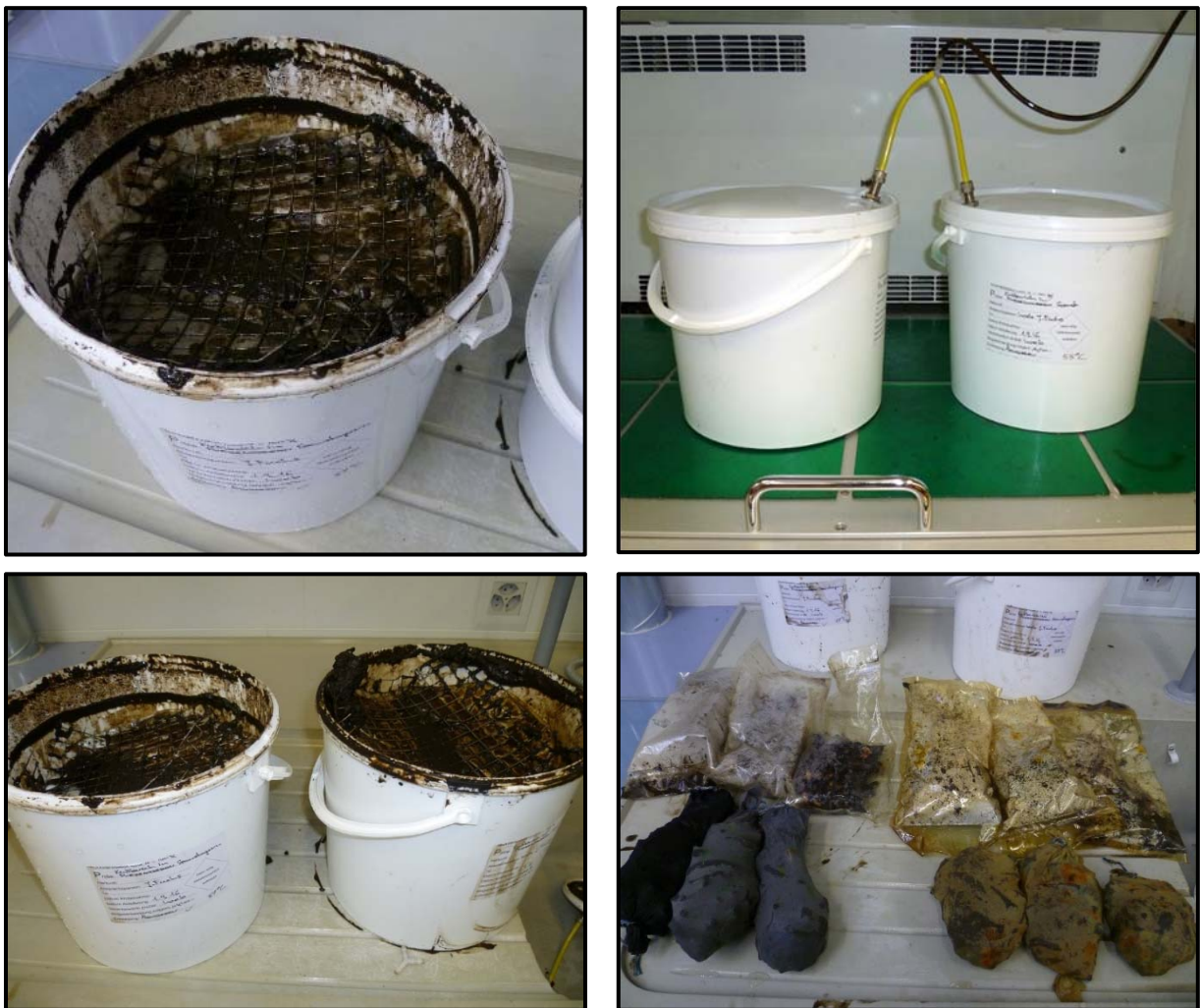
Abb. 5. Expositionstest unter anaeroben Laborbedingungen Oben links: Presswasservorlage Oben rechts: geschlossene Kunststoffgefäße mit Entgasung im Schüttler Unten links: Presswasservorlagen Unten rechts: Probenbeutel nach der Exposition
