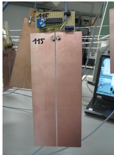
Abbildung 15: Aufbau eines Feuchtesensors
