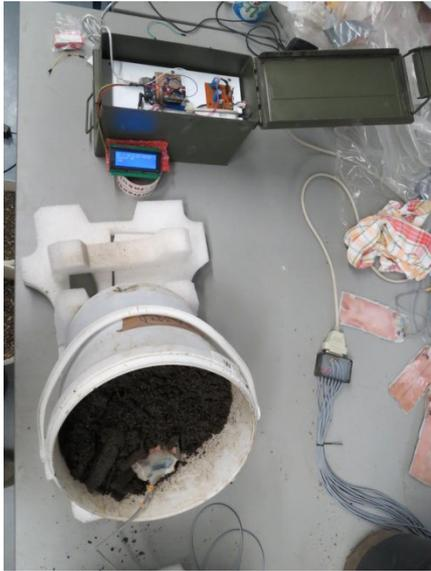
**Abbildung 16: Auslesegerät (oben) beim Kalibrieren eines fertigen Sensors**
