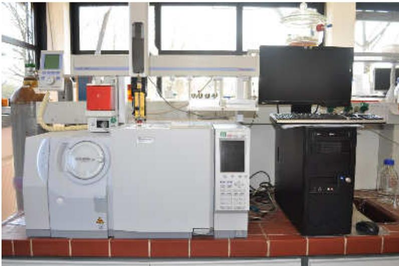
Abbildung 3: chemische Analyse mittels Gaschromatographen (GC). Linker Teil: Gaschromatograph (weiß), Rechter Teil: Aufzeichnungen der Analyse auf einem Monitor (schwarz)
