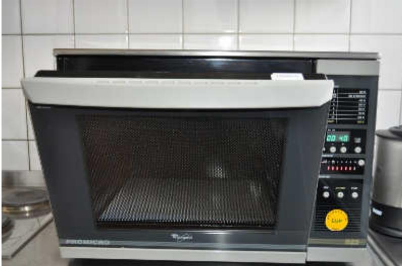
*Abbildung 6: handelsübliche Mikrowelle zur Erhitzung der Speckproben bei 800 W für 45 Sekunden.*
