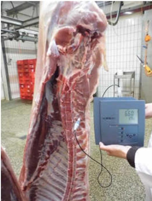
Abbildung 14: Messung des  $pH_1$ -Wertes mit dem pH-Wert-Messgerät Inolab 720 von WTW im Musculus longissimus dorsi.
