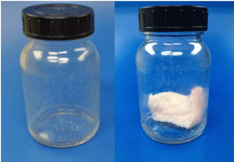
*Abbildung 7: Verschießbare Gläser zur Erhitzung von Speckproben*
