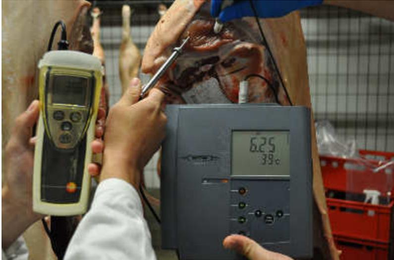
Abbildung 13: Messung der Temperatur mit Hilfe eines Einstich-Thermometers und Messung des  $pH_1$ -Wertes mit dem pH-Wert-Messgerät Inolab pH 720 von WTW im Musculus semimembranosus.
