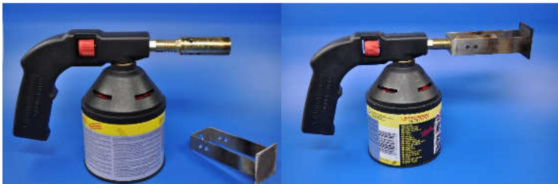
*Abbildung 5: Gasbrenner mit Metallplatte. Die Metallplatte wird ca. 4 cm vor die Flamme montiert und erhitzt. Anschließend wird das erhitzte Metall auf die entsprechende Stelle gedrückt.*
