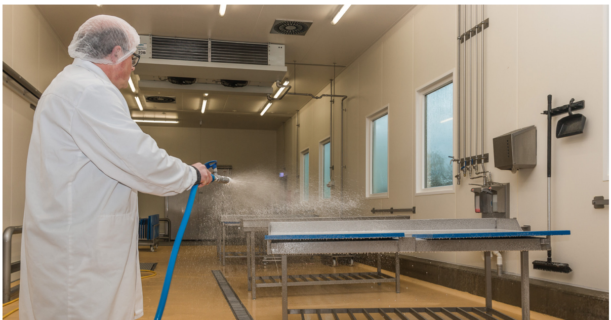
Schmutz wird von dem Reinigungsmittel emulgiert und kann so leicht entfernt werden
