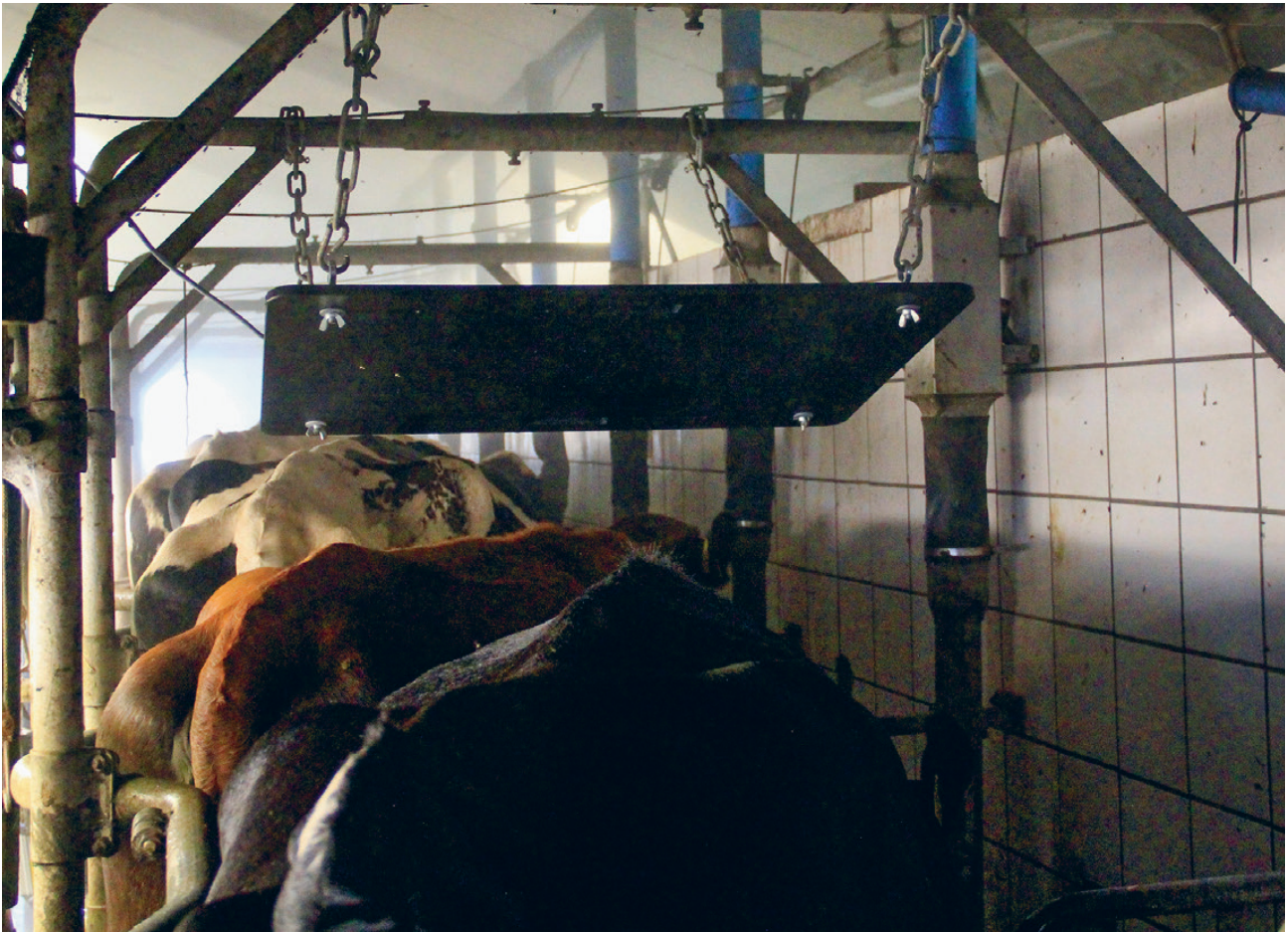
Den flytbare pladeantenne over køerne aflæser de elektroniske øremærker, når køerne går ind i malkestalden. Ko-numrene overføres derefter trådløst til datahandleren. Foto: Jonas Persson
