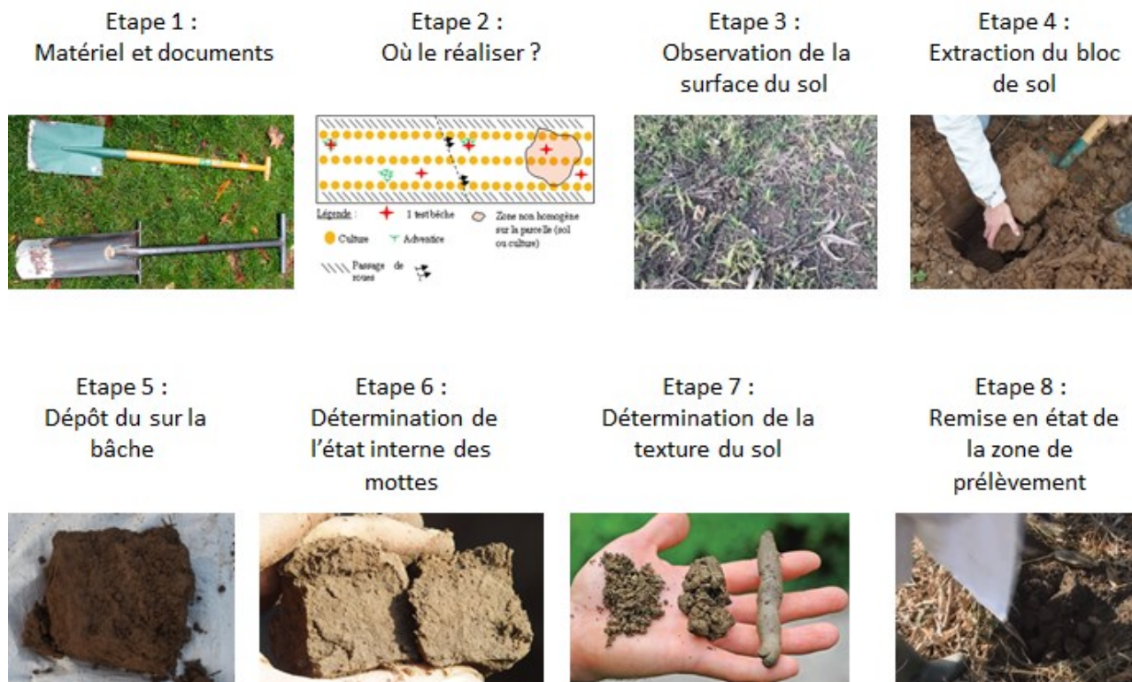
Figure 1: Les 8 étapes du test bêche
