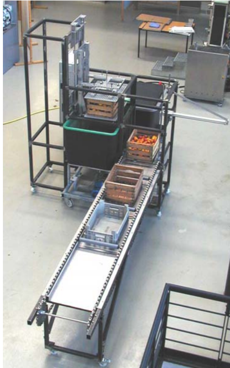
Abb. 7: Optimierte Heißwassertauchanlage für den (halb-)kontinuierlichen Betrieb
