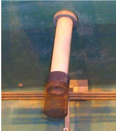
Abb. 5: Linke Abbildung Grobsieb am Einsaugrohr der Pumpe, rechte Abbildung Prallblech am Wassereintritt in den Tauchbehälter.
