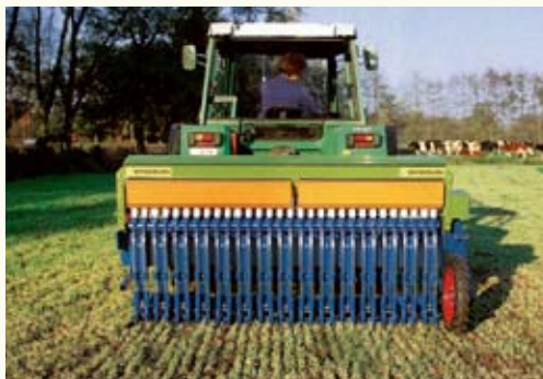
De doorzaaimachine is geschikt voor vlakke percelen. In vochtige bodem verstopt en versmeert ze minder dan de strokenfrees.
