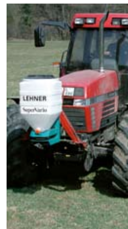
In combinatie met een eg en een aandrukrol is een slakkenkorrelstrooier zeer geschikt voor het doorzaaien.
