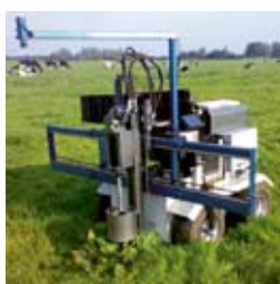
De zelfrijdende robot 'Ruud' verplaatst zich met het RTK-GPS navigatiesysteem. Met een camera spoort hij de zuringplanten op en vernietigt deze met behulp van een freeskop.
