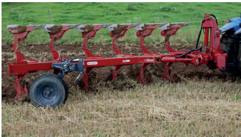
Kõrrekoorimine madakünni adraga (Precilab). Küntakse vaid 10 cm sügavuselt. Sügavust saab reguleerida toestava rattaga. Umbrohujuured lõigatakse läbi ja tuuakse pinnale, kus nad kuivavad.
