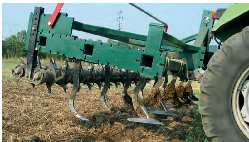
Kultivaator, mis lõikab läbi kogu mullapinna, saavutab põldohaka tõrjel adraga võrreldava tulemuse. Erinevalt atradest mulda ümber ei pöörata.
