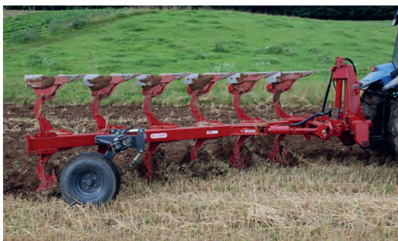
Tarlóhántás előhántós ekével (Precilab). Csak a felső 10 cm-es réteget szántják. A mélység a mankókerék segítségével állítható. A mélyen gyökerező gyomnövényeket kettévágják, és a felszínre forgatják, ahol elszáradnak.
