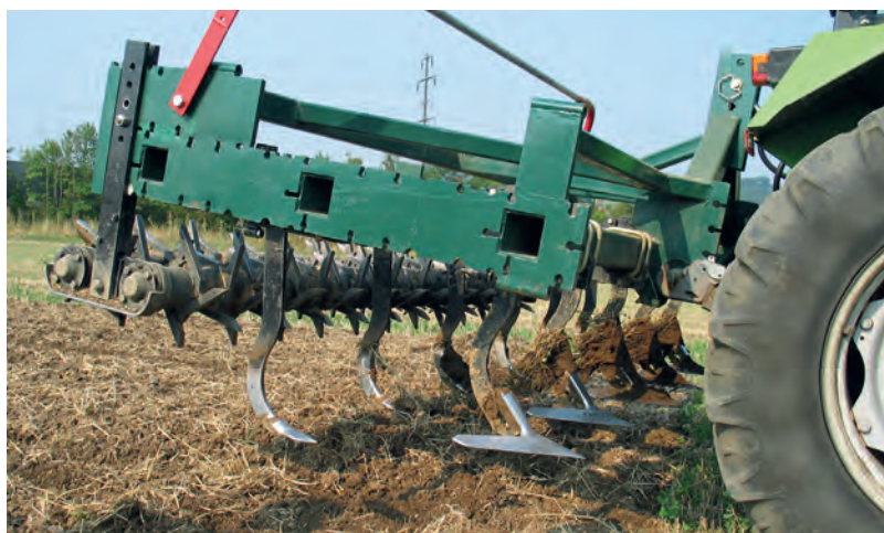
A szántóföldi kultivátor (mely a teljes felületet átvágja) hasonlóan hatékony eredményt ér el a mélyen gyökerező gyomnövények esetében, mint a tarlóhántó eke vagy az előhántós eke. Viszont az előhántós, illetve tarlóhántó ekével szemben nem forgatja a talajt.
