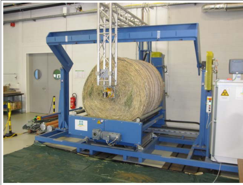
Abbildung 3.10: Messungen mit dem radiometrischen Dichteprüfstand im DLG-Testzentrum
