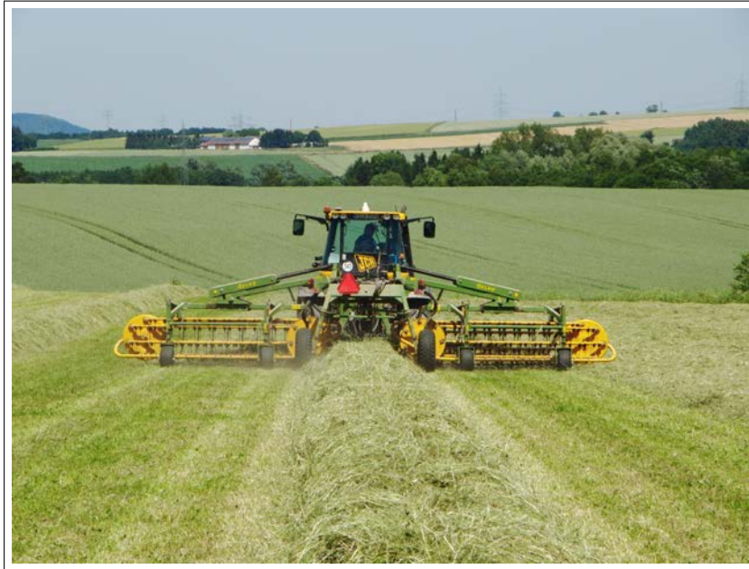
Abbildung 3.9: Profil der mit dem ELHO Schubrechschwader erzeugten Schwade
