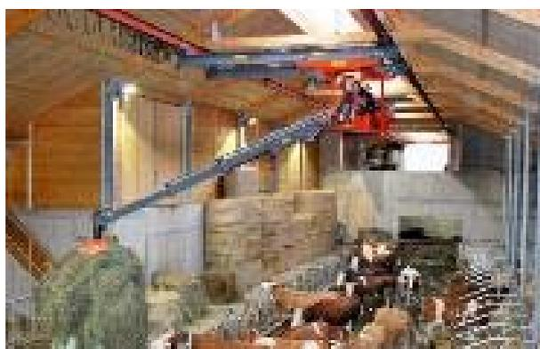
Zur Einlagerung und teilweise auch zur direkten Futtervorlage kommen Hängedrehkräne zum Einsatz. Um große Reichweiten zu erzielen, werden Teleskoparme eingesetzt. Auch ein Querfahrwerk erhöht den Aktionsradius (Abb. 7). Kurvenfahrten sind ebenso möglich. Wichtig ist die Hubleistung des Krans, die in Metern (mt) gemessen wird. Üblich sind 5–6 mt, was bedeutet, dass der Kran bei ausgefahrenem Teleskoparm auf 6 m noch 1 Tonne heben kann.
