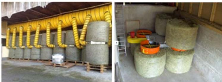
Abb. 9: Rundballentrocknung mit flexiblen Zwischenringen (einzeln) (links) und als Kompaktanlage (rechts) (Firmenbilder [www.lasco.at/rundballentrocknung](http://www.lasco.at/rundballentrocknung) 2016, [www.2015.rmh.at/rmh-rundballenbelueftung](http://www.2015.rmh.at/rmh-rundballenbelueftung) 2016)
