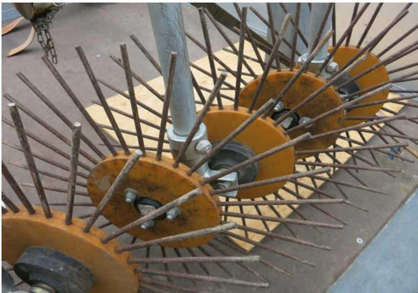
Abb. 3.2.12: Sternförmige Arbeitswerkzeuge auf Kunststoffscheibe am Turbo-Rollstriegel (Hersteller: Fa. Annaburger), Aufnahme: R. Jung, 18.5.2015.
