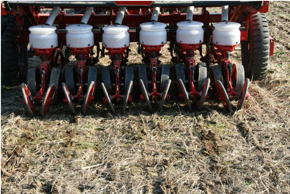
Bild 3.1.1: Direktsaat von Ackerbohnen in Haferstroh mit der Sämaschine SEMEATO SHM 11/13, Bild: J. Siebigteroth
