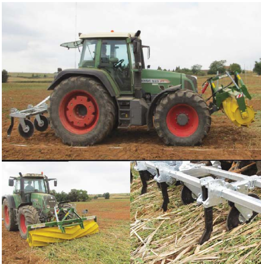
Figura 4. Tractor equipado con el in-line tiller y roller crimper, diseñados y construidos por la empresa SOLD0 y adquiridos por el equipo de investigación en el marco del proyecto SoilVeg (arriba), detalle del roller-crimper (abajo izda) y del in-line tiller (abajo dcha).
