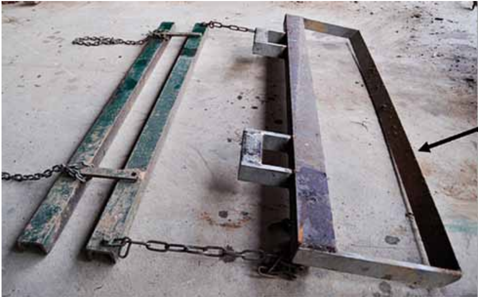
Abb. 2.5.2: Unterschneidemesser: das eigentliche Messer (s. Pfeil) ursprünglich aus Federstahl, jetzt aus Kostengründen handelsüblicher Baustahl. Eine Möglichkeit, wäre, Schleifschienen für Frontladerschaufeln, die als Meterware erhältlich sind, zu verwenden. (Foto: A. Müller)
