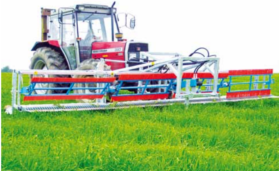
Abb. 5.5. 1: Weed Cutter CombCut® ist ein leichtes Gerät, das im Frontanbau betrieben wird Foto: Jonas Carlsson, JustCommonSence AB
