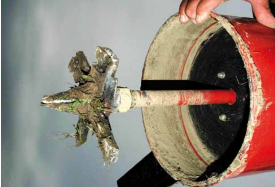
Abb. 5.3-3: Der „Ampferwiesel“ zerkleinert die Ampferwurzel mit einem rotierenden Fräskopf. Im Versuch trieben die zerkleinerten Wurzelstücke wieder aus.
