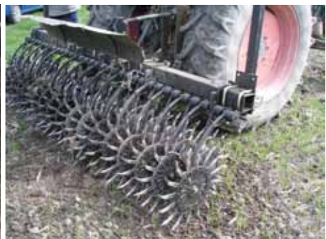
Sternhacke (max. 1,5 cm bei 15 km/h)
