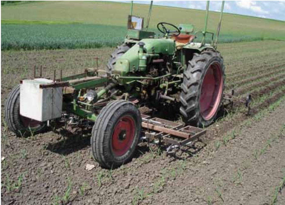
Abb. 4.2.6: Mais wird gehackt und dadurch leicht angehüfelt. Das Gerät ist ein Eigenbau
