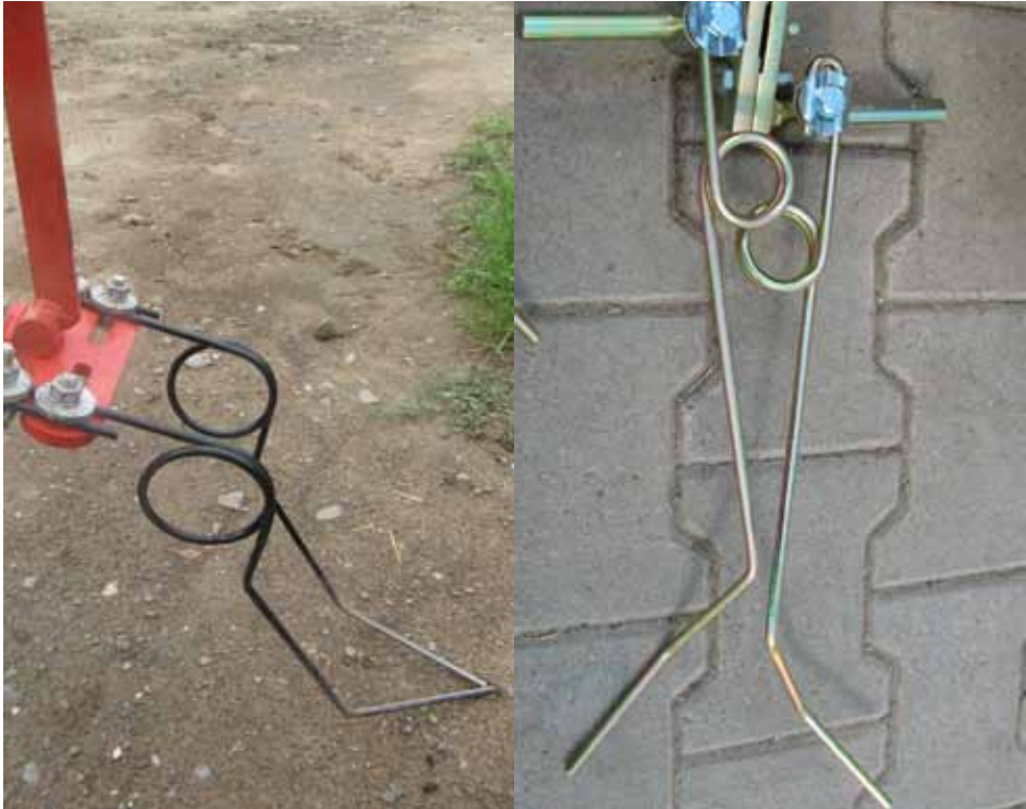
Abb. 3.7.5: Links: Die verstellbare Halterung, wie sie auf Nachfrage von Fa. Frato gefertigt wird. Hier mit Stielquerschnitt 10 x 30 mm. Rechts: Torsionshacke anderen Fabrikats zum Aufstecken auf den Stiel eines Hackschars (10 x 30 mm). Die Zinken sind über den Rundstiel mit einer Schraube in ihrer Neigung sowohl nach unten zum Boden als auch seitlich zur Pflanze verstellbar (Bezug: Fa. Kress).
