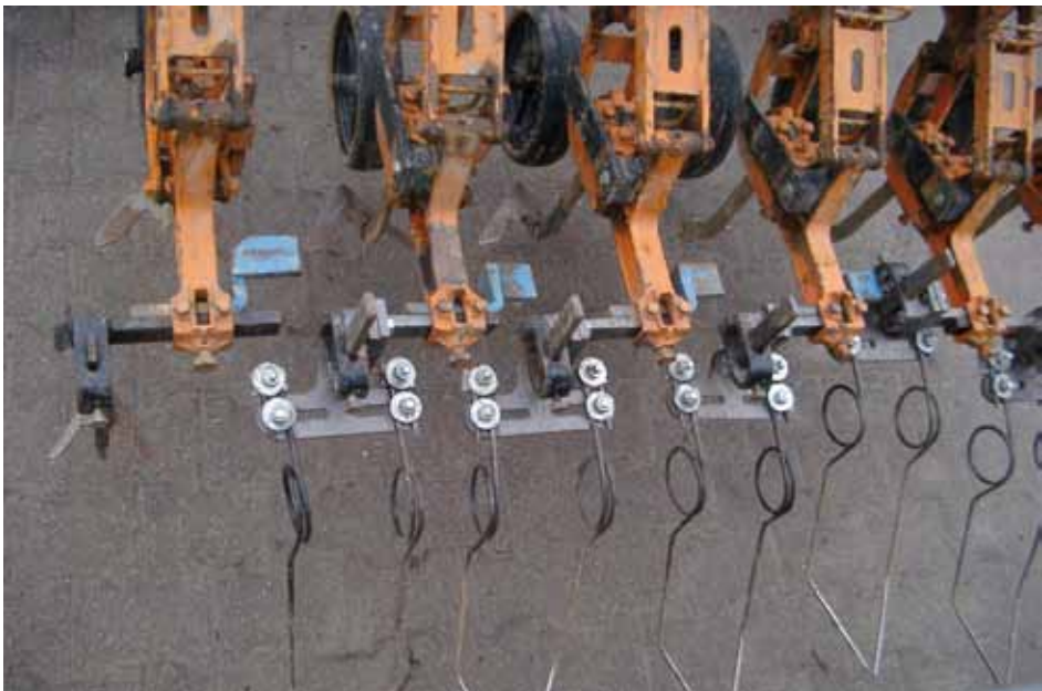
Abb. 3.7.2: Befestigung der Torsionselemente an den seitlichen Auslegern des Schotter-Parallelogramms mit vorauslaufenden Gänsefußscharen in der mittleren Aufnahme des Parallelogramms
