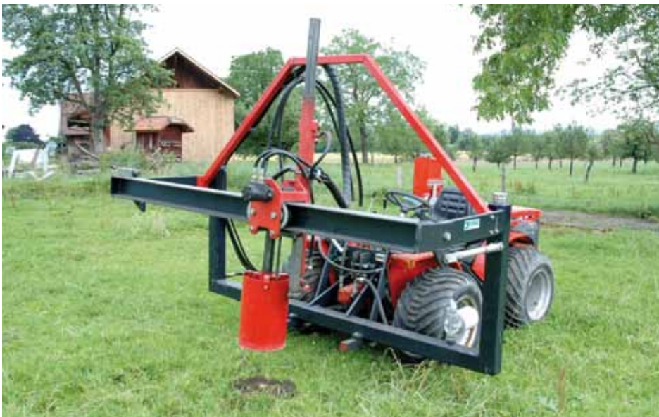
Abb. 5.3.2: Mechanische Ampferbekämpfungseinheiten: WUZI mit hydraulischer Ausreisszange (oben); Ampferwiesel mit rotierendem Fräskopf (unten)
