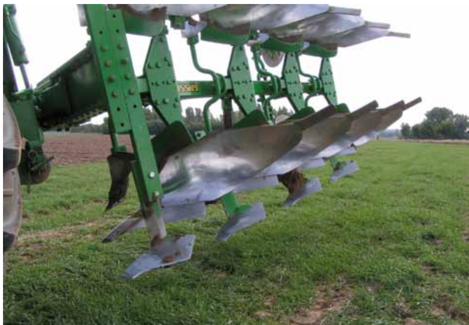
Abb. 2.2.2: Aufbau eines Pfluges, wie er im Versuch eingesetzt wurde. Die Lockerungswerkzeuge unterhalb der Pflugkörper können wahlweise montiert werden und wurden nicht in jedem Jahr verwendet.
