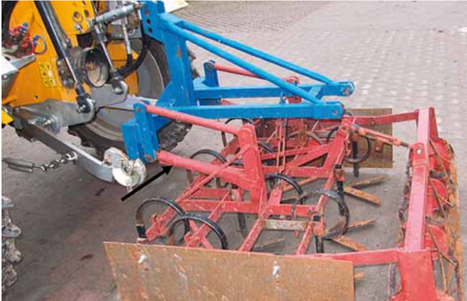
Abb. 2.5.4: Umgebaut aus einer Güttler- Kulti-Egge. Höhenführung über die nachlaufende Walze und Oberlenker, das Parallelogramm (s. Pfeil) unterstützt die gleichmäßige Höhenführung bei Unebenheiten
