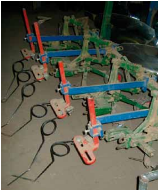
Abb. 3.7.4: Hier wurde mit einer selbstgebauten Halterung (blau) die Torsionshacke nicht am Parallelogramm sondern direkt am Hackrahmen befestigt, so dass die Zinken hinter dem Parallelogramm laufen. Der Neigungswinkel beträgt ebenfalls ca. 15^\circ .
