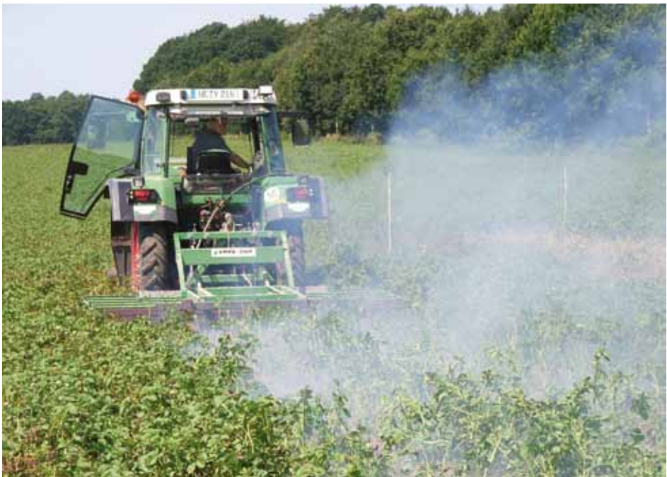
Abb. 4.14.2: Abflammergerät der dänischen Firma Envo-Dan mit 3,20 m Arbeitsbreite (Gerät verbrennt aus der Flüssig-Phase)
