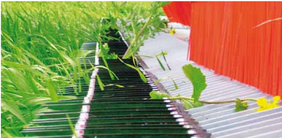
Abb. 5.5.4: Der Cutter kann mit einem nach vorne gerichteten Kamm mit Messern verglichen werden. Die dünnen, biegsamen Getreidehalme passieren die fixierten Messer unbeschadet. Die steifen, dicken Beikrautstängel werden abgeschnitten. Foto: Jonas Carlsson, JustCommonSense AB
