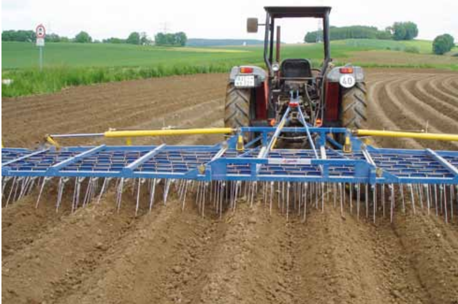
Abb. 4.2.4: Striegeln von Kartoffeldämmen. Anhand dieses Bildes ist die Anpassung der Zinken an die unterschiedlichen Bodenverhältnisse sehr gut erkennbar. Somit erfolgt auch an den Dammhängen eine mechanische Unkrautregulierung
