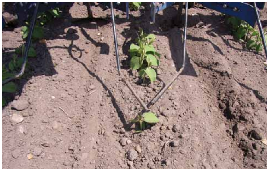
Abb. 3.7.1: Hier ist die Wirkung der Zinken im Boden zu sehen - bis an die Pflanzenreihe heran. Foto: Markus Mücke
