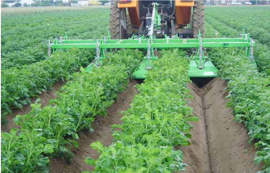
Abb. 4.13.3: Die Dammformbleche sind am Hinterbalken montiert und drücken den abgestreiften Boden wieder an die Dammseiten an (Foto: AVR)
