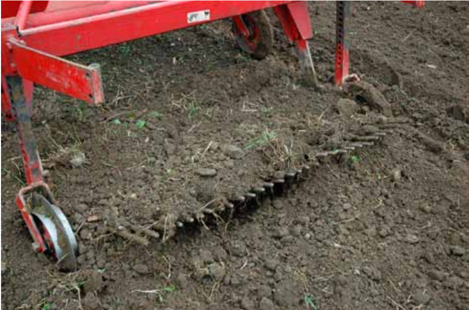
Abb. 2.6.4: Schwingsiebroder befördern Wurzeln an die Oberfläche
