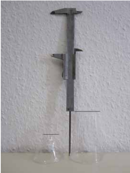
Abb. 3.1.2: Messung der Becherhöhe mittels Messschieber
