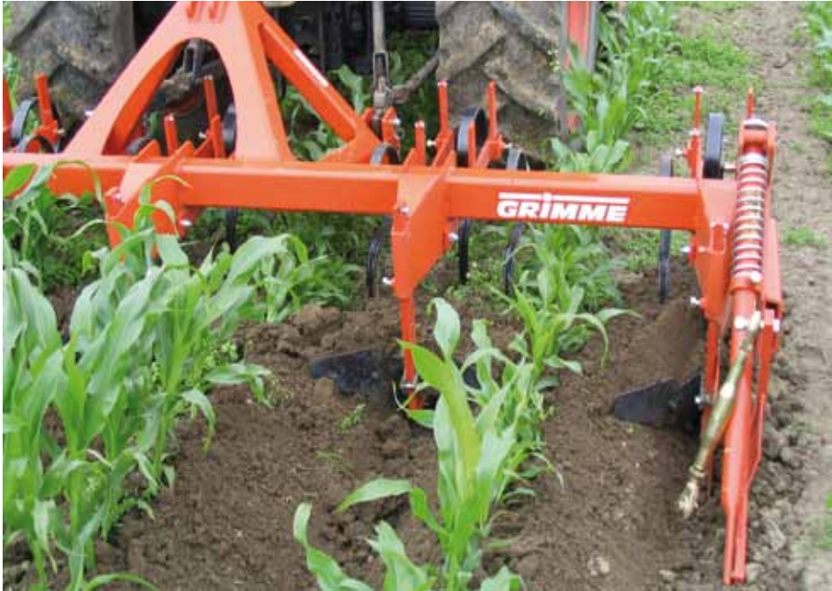
Abb. 4.8.1: Häufeln ohne Blech bei größeren Maispflanzen
