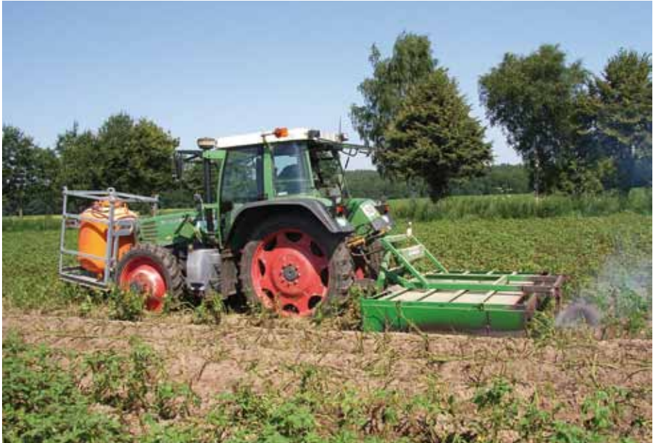
Abb. 4.14.1: 320 kg Fronttank (Fa. Primagas)
