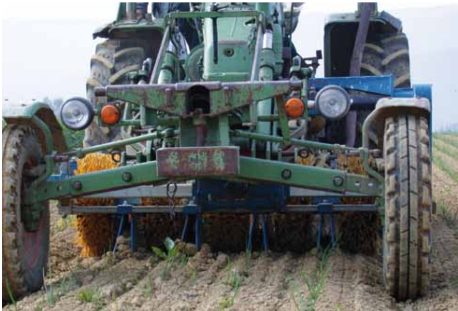
Abb.3.4.3: Die Hackbürste enterdet die Beikräuter gut. Nachteilig ist, dass sie sich nicht an Bodenunebenheiten anpasst (daher: ebener Beetanbau notwendig) und bedingt durch die Bauart nur im frühen Kulturstadium (bzw. bei wenig Blattmasse) angewendet werden kann
