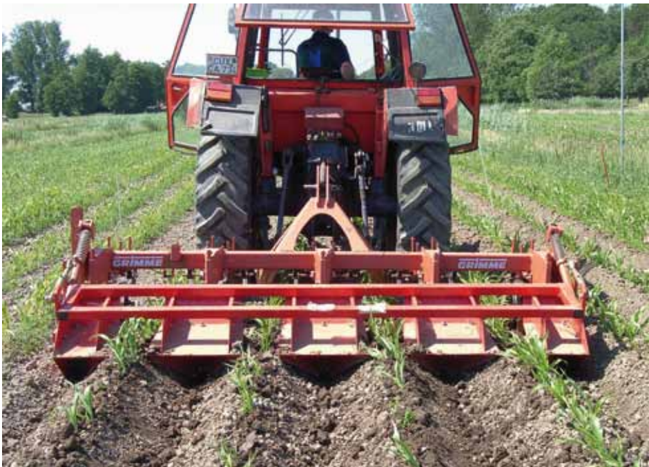
Abb. 4.8.2: Im frühen Entwicklungsstadium ist der Einsatz von Schutzblechen zu empfehlen, um ein Verschütten der Maispflanzen zu verhindern
