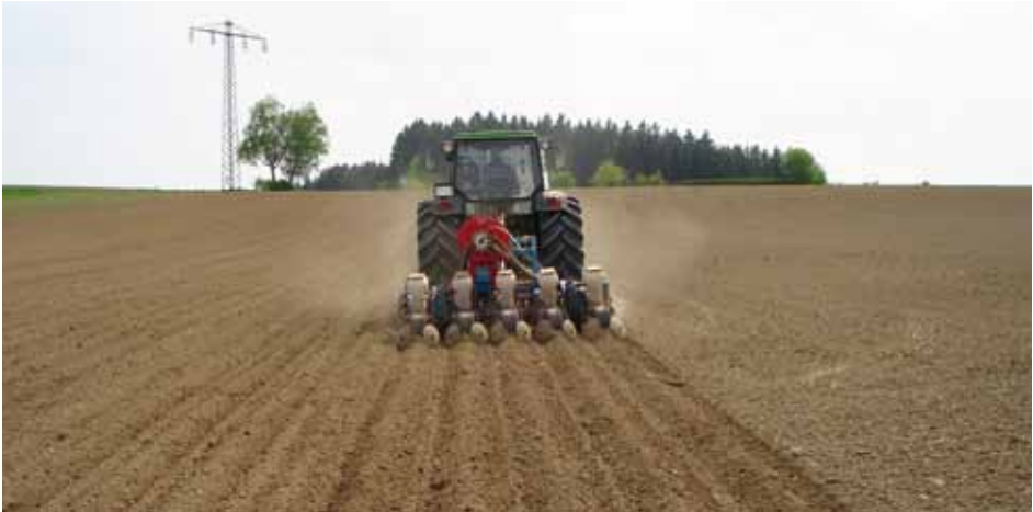
Abb. 4.2.2: Saatbettbereitung mit Grubber und Kreiselegge
