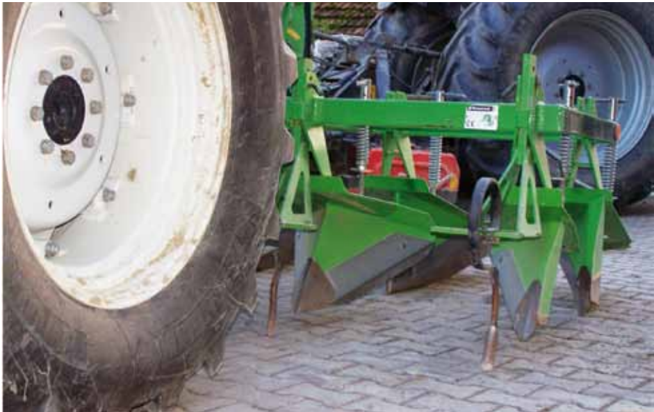
Abb. 4.13.2: Der AVR-Ecoridger ist ein Kombinationsgerät. Die so genannten Abstreifelemente streifen eine dünne Erdschicht und das Beikraut von den Rückenseiten der Dämme ab. (Foto: Christian Landzettel)
