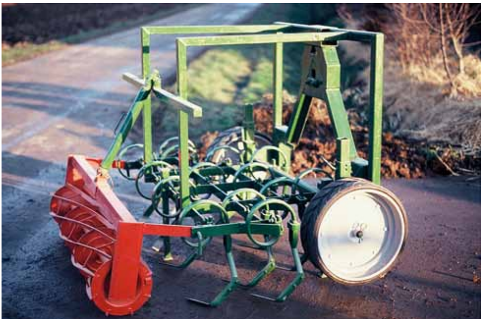
Abb. 2.5.5: Exakte Höhenführung auf dem Beet durch zwei Farmflexräder vorne und die Krümelwalze hinten (Foto: G. Eisenkolb)
