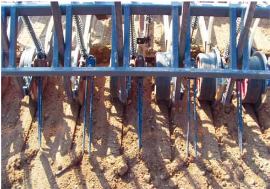
Abb. 3.6.4: Säen ohne seitliches Spiel, mit exakter Tiefenablage
