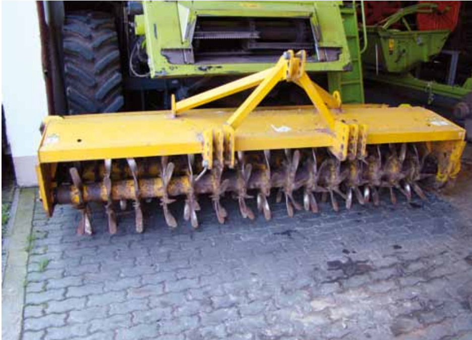
Abb. 2.4 5: Der Dyna Drive ist ein Boden angetriebenes Gerät, das den Boden sehr flach (1-2 cm) bearbeiten kann
