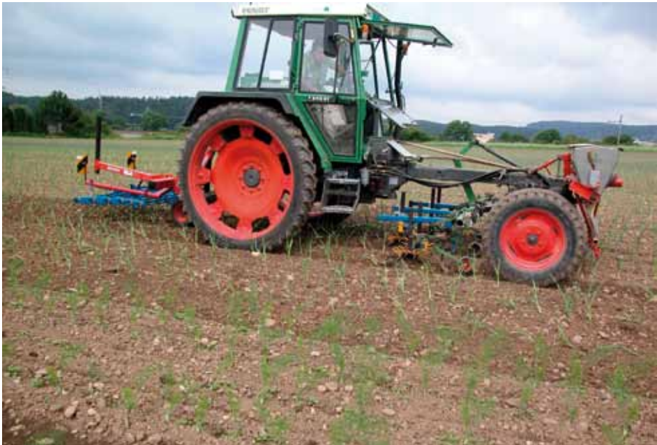
Abb. 3.3.3: Fingerhacke im Zwischenachsbereich und im Heckanbau ein Beetstriegel mit Radführung für die präzise Höheneinstellung im Lauchanbau (Bild R. Total, ACW Wädenswil)
