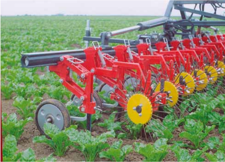
Abb.4.3.1: Die Hackmesser-Rollstriegel-Kombination (Annaburger Uni-Hacke) im Einsatz auf einem Zuckerrübenfeld (Foto: Rumpler)
