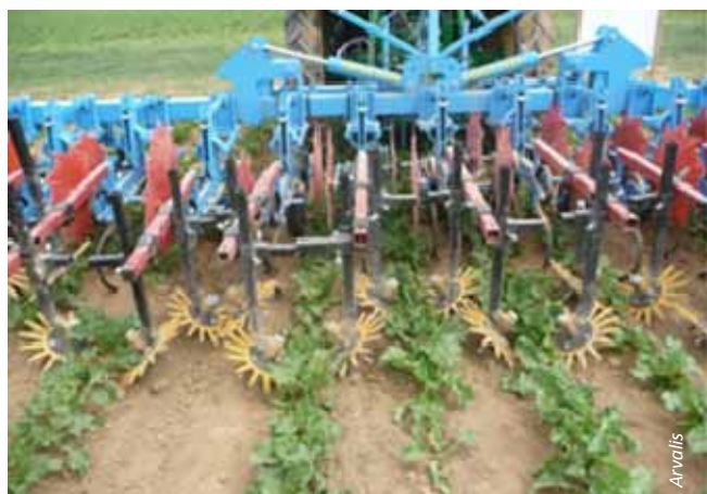
Bineuse à doigts Kreiss en action
