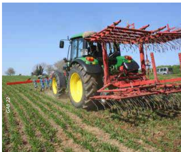
Herse étrille associée à une bineuse à l'avant
