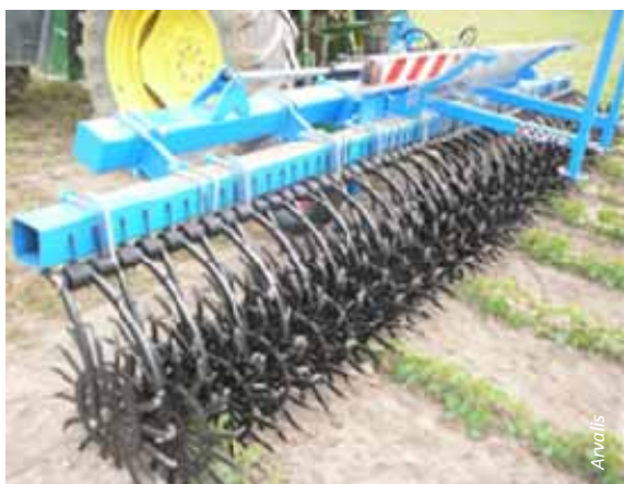
Gros plan d'une houe rotative (dans du soja)
