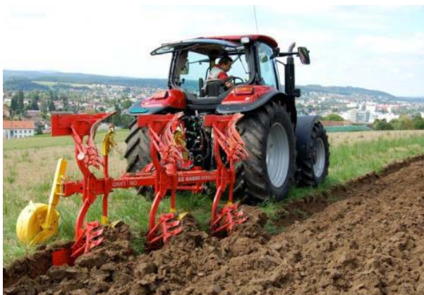
Специалният плуг (on-land plough) помага за предотвратяване на уплътняването на почвата в браздата.
