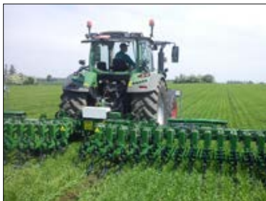
Billede 1. Kamerastyret Garford-radrenser med parallellophængte renseskær.
