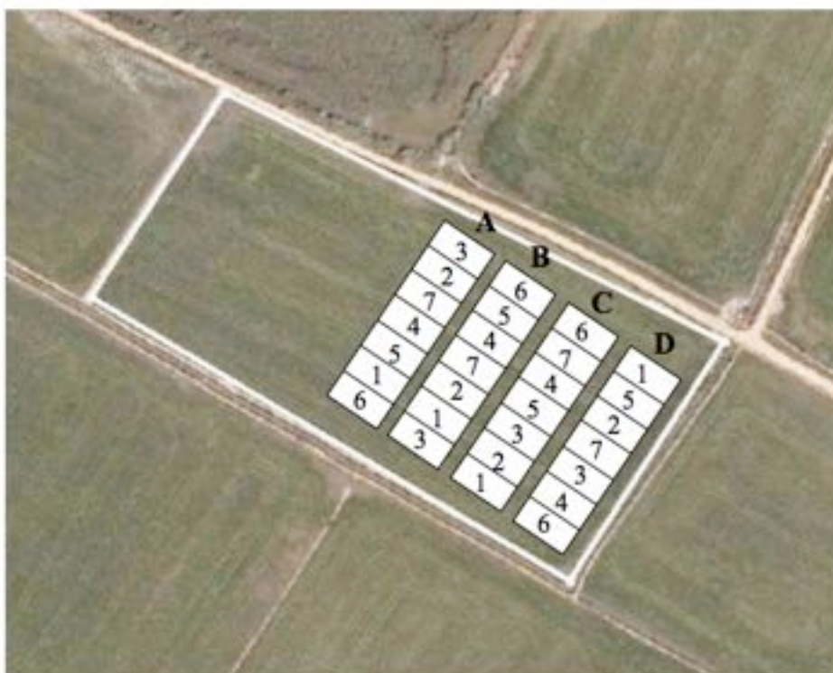
Figura 1: diseño experimental del ensayo de abonado en la parcela J. Los números 1 a 7 corresponden a dosis de 0, 55, 83 y 110 kgN/ha de Labinor y 29, 44 y 59 kgN/ha de Naturgan, respectivamente. Las letras A, B, C y D corresponden a las repeticiones.
