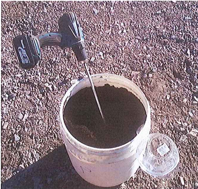
Figur 3.1. Blanding av aske med vann med malingsomrører.
