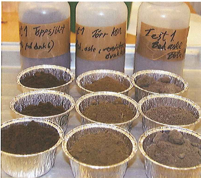
Figur 3.9. Prøver tatt fra venstre til høyre fra: topp, midt og bunn av kolonnen.
