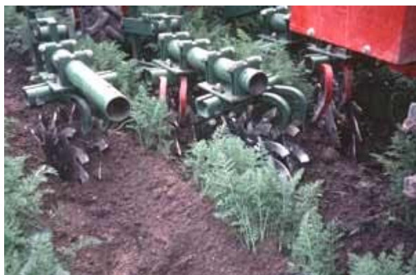
Anhäufeln verschüttet keimendes Unkraut in der Kulturreihe. Für diese Arbeit verwendet man Häufelkörper oder der Sternhacke (Bild).
