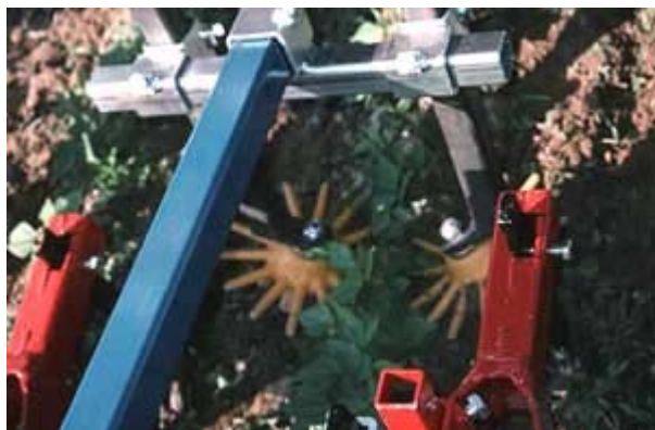
Mit ihren Kunststoff-Fingern erreicht die Fingerhacke auch die Zone in der Reihe. Sie ist für den Einsatz in Bohnen, Kohlarten, Lauch oder Zwiebeln geeignet.
