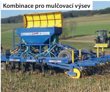
Secí stroj s rotavátorem pro pásový výsev
