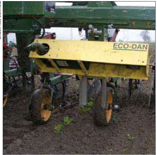
Die Kameras im gelben Kasten sind die «Augen» des Hackgeräts.
