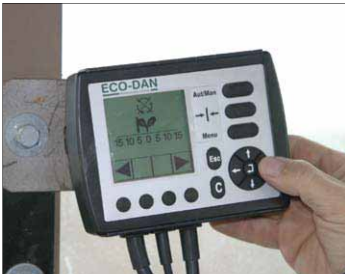
Display in der Traktorkabine für die Feineinstellung.
