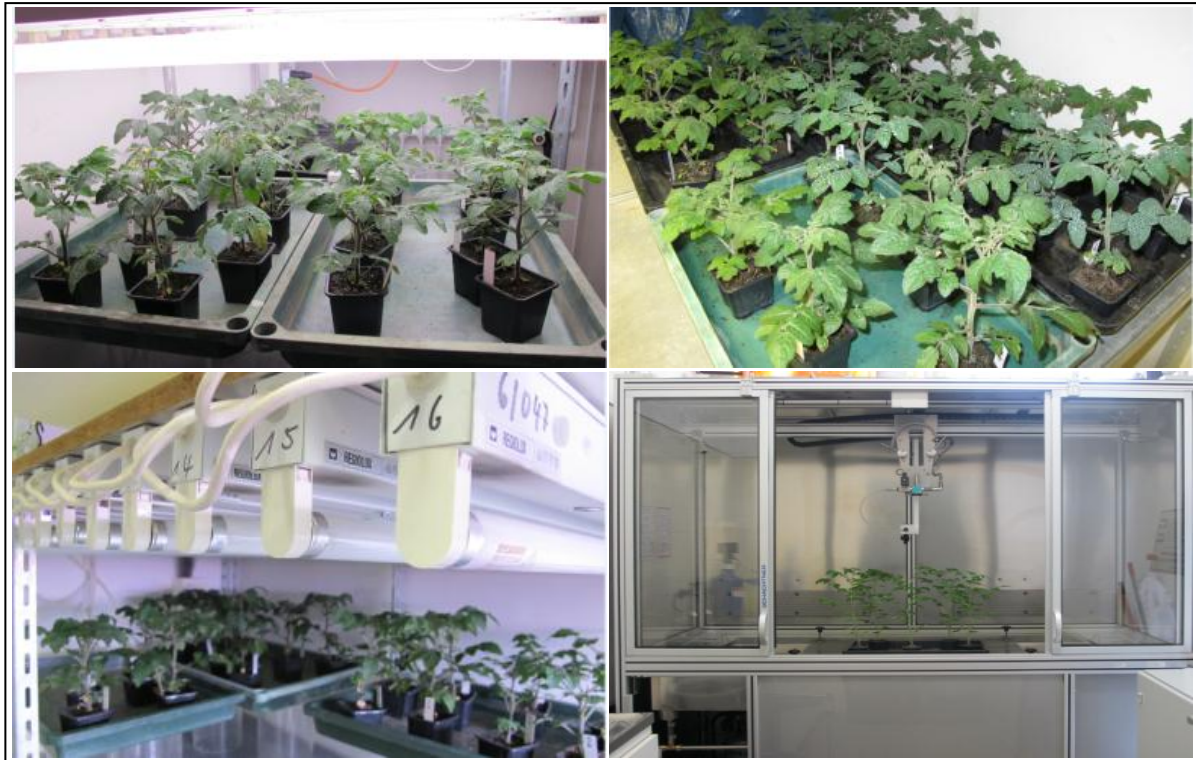
Abbildung 5: Versuchsaufbau zur Prüfung der UV-Stabilität von Süßholzformulierungen in Tomate. Bild rechts oben: Formulierungen von Süßholz im UV-Test an getopften Tomaten der Sorte 'Minibell', Bild links oben und unten: Bestrahlung der Pflanzen mit Sylvania UV-Vollspektrum-Röhren (30 % höherer UV-Anteil), bis zu 7 Tage nach Behandlung und über 16 h pro Tag; Bild rechts unten: SCHACHTNER Applikationsanlage mit Düse über Kopf der Pflanzen.
