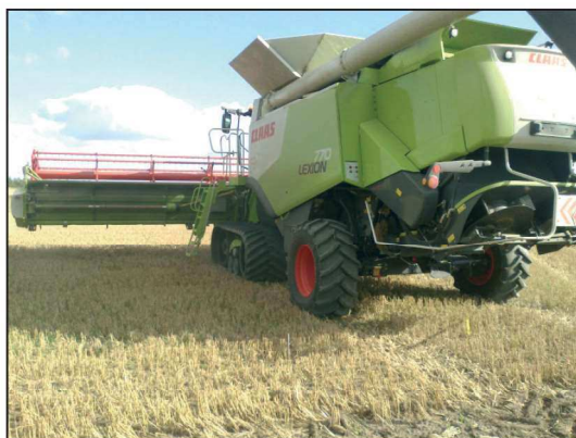
Billede 2. Den anden mejetærsker i forsøget var en Claas 770 TT med 90 cm brede bælter. Foto: Jes Hasselbalch.
