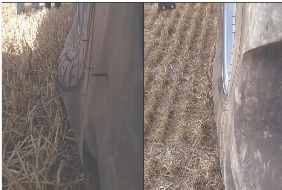
Billede 3. Der er tydelig visuel forskel på om der er 1,6 bar (t.v.) eller 2,75 bar i dækket. Hjullasten på de to mejetærskere blev justeret til 10 ton ved at tilpasse mængden af korn i tanken. Føreren gav udtryk for, at mejetærskeren havde lidt vuggende bevægelser med det lave dæktryk. Erfaringen fra bæltemejetærskere er, at skærebordet holder sig meget roligt. Foto: Jes Hasselbalch.
