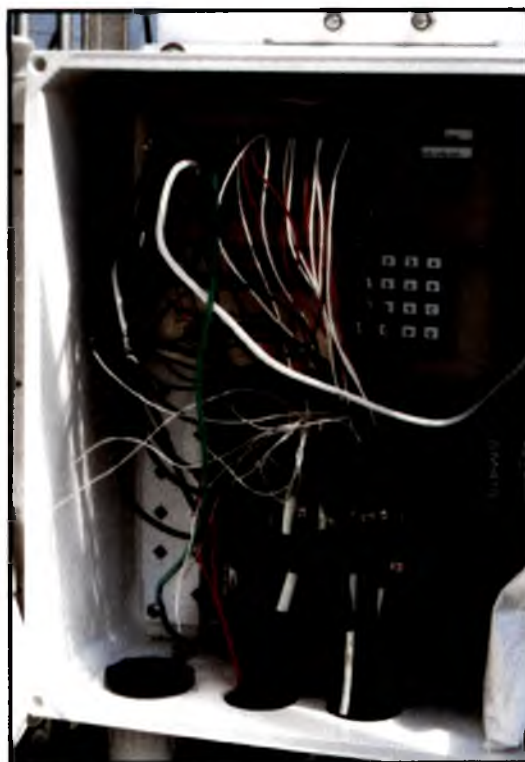
FIGURA 9B – Aspecto da conexão dos sensores no micrologger e no multiplexador.
