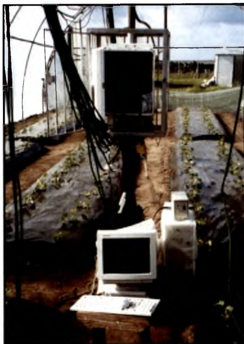
FIGURA 9A – Aspecto da conexão entre o micrologger e o computador durante a extração dos dados armazenados.
