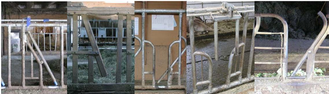
**Abb. 16: Fressgitter-Typen (von links nach rechts): Parallelogramm-Selbstfangfressgitter, Schiebbarren-Fressgitter (geschlossen), begrenztes Schwedenfressgitter, Fressgitter Typ Öko (begrenzt) und Schwedenfressgitter (offen)**
