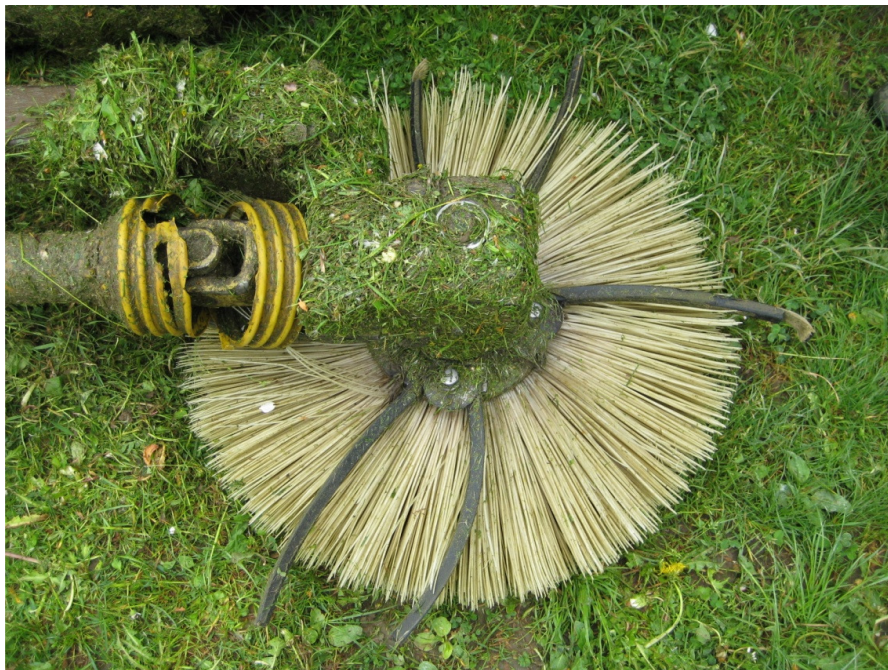
Abbildung 21: Bürste zur Bodenbearbeitung in der Reihe (Konstruktion eines Betriebsleiters)
