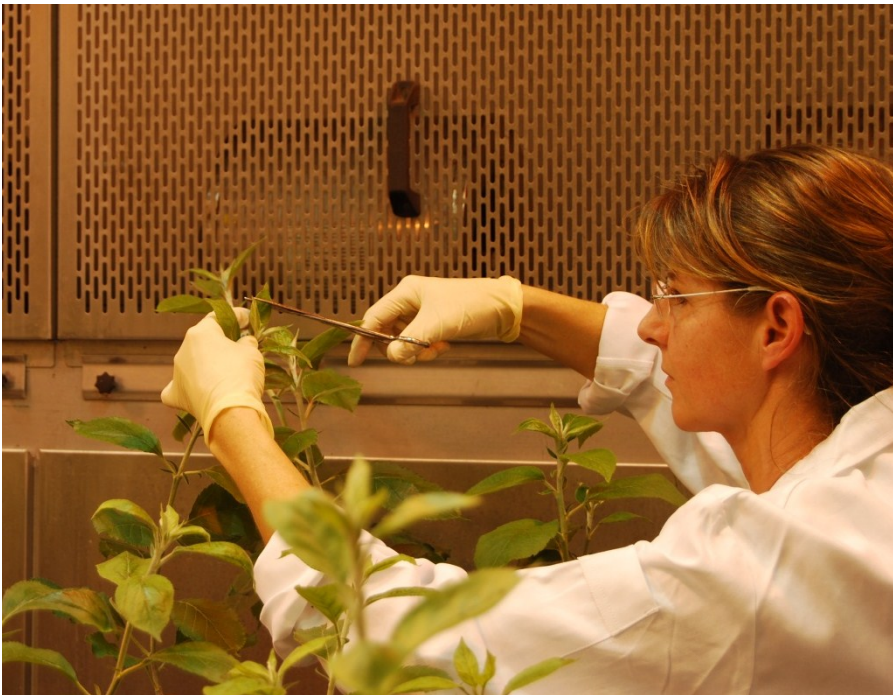
Abbildung 3: Inokulation von Apfeltrieben (Sorte Jonagold) mit einer in eine Bakteriensuspension ( 10^9 E. amylovora /ml) getauchten Schere.
