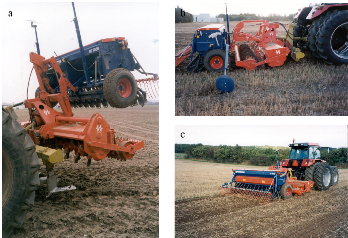
Figur 2. Dutzi-udstyret i arbejde. a) transportsituation for det fulde Dutzi-system (brugt i forsøgsled C), b) og c) det fulde Dutzi-system i arbejde, d) løsning med Dutzi-tænderne separat (forsøgsled D) (foto: Peter S. Nielsen). The tillage implements used in treatments C and D. a) the complete system in transport position, b) and c) the full Dutzi implement in the field, d) separate soil loosening with Dutzi tines (treatment D).
