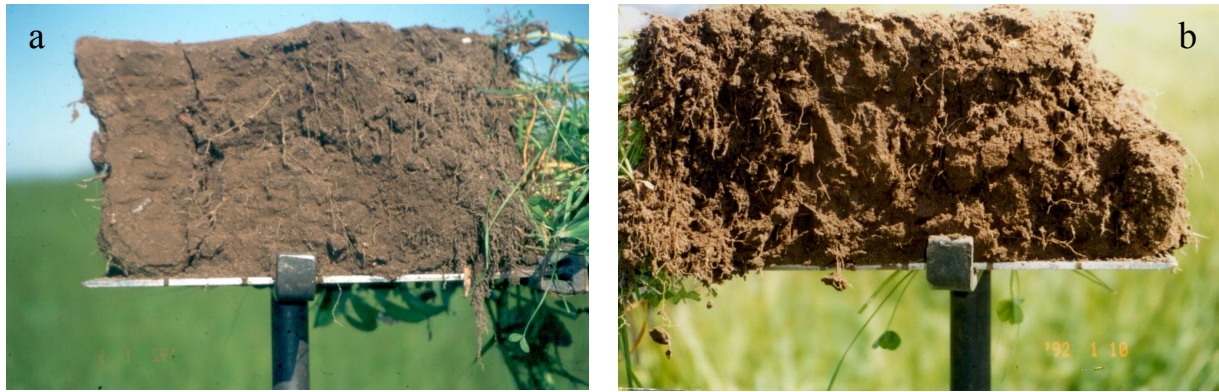
Figur 12. Prøver af de øverste 30 cm jord sommeren 1998, mark B4. a) forsøgsleddet med traditionel pløjning og b) det Dutzi-behandlede forsøgsled. Bemærk, at Dutzi-behandlingen har brudt den kompakte pløjesål op og givet anledning til forøget rod-vækst (foto: Lars J. Munkholm). Blocks of soil sampled from the top 30 cm of the B4 field, summer 1998. a) soil from the traditionally ploughed treatment and b) the Dutzi treatment. Notice how the Dutzi treatment has broken up the plough pan and allowed an increased root growth in this soil layer.
