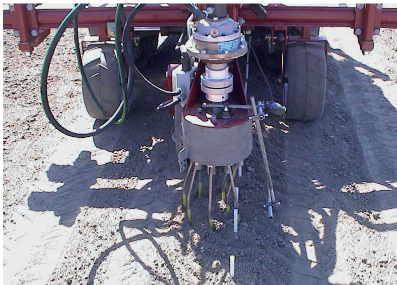
Figur 2. Cycloid hoe til bekæmpelse af ukrudt i rækken er baseret på RTK-GPS identifikation af kulturplanter og har roterende tænder. Foto: Michael Nørremark.
