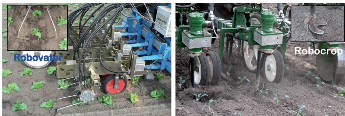
Figur 1. Kommercielle mekaniske renser til bekæmpelse af ukrudt i rækken.
