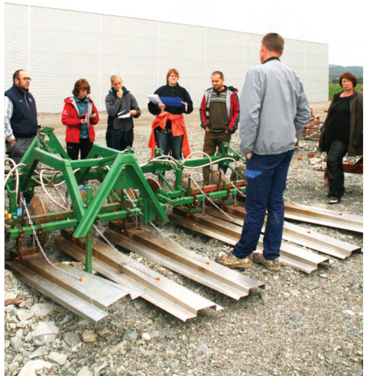
Hans Kjæraas Finstad gård i Sande i Vestfold har laga en traktormontert propanbrenner som dekker 3 senger.
