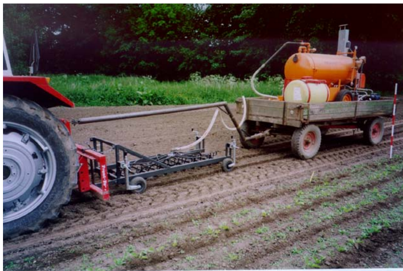
Figur 3. En prototype på en sribedamper med en 200 kW dampgenerator. På rammen ophængt i traktorens 3-punktsophæng er der på langs monteret 13 dampdyser dannende en 7 cm bred zone, som dampes ved nedsænkning af dyserne i jorden.
