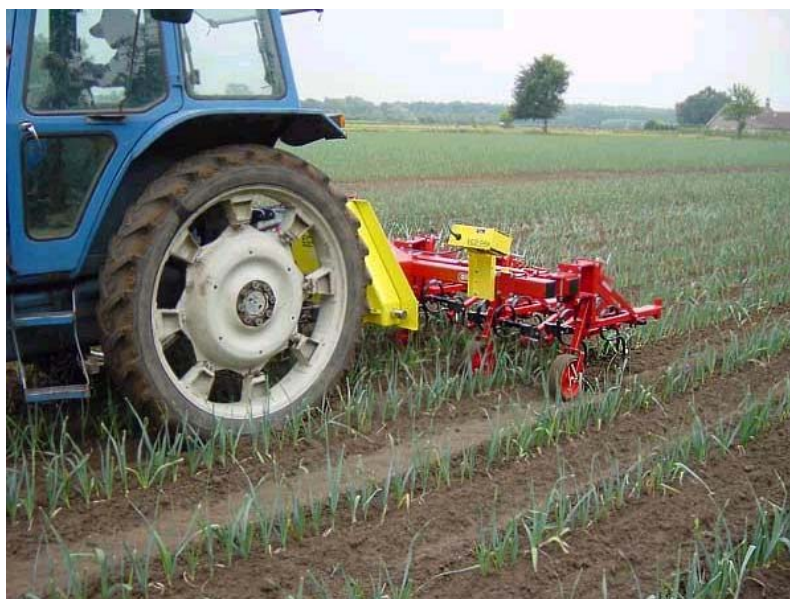
Figur 4. Radrensning i løg med Eco-Dans automatiske styresystem.
