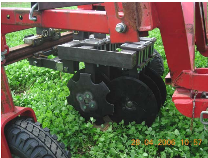
Abbildung 10: Prototyp des bodengetriebenen Reihenmulchers des Instituts für Landtechnik, Universität Giessen
