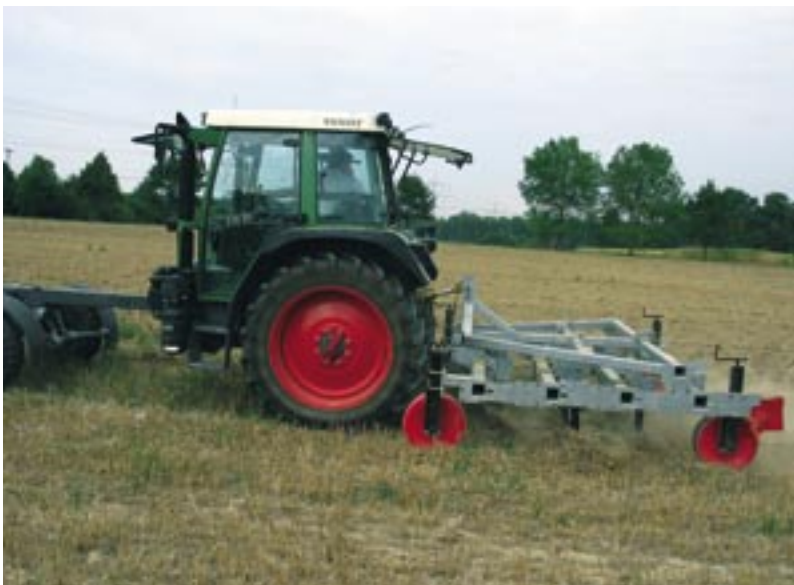
Die zähen Distelstopeln erfordern für die Stoppelpbearbeitung eine Überlappung der Scharen von mindestens 10 cm.
