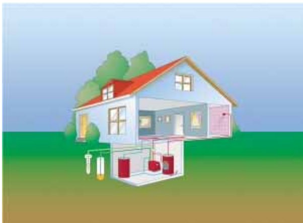
Bild 1: Anlage mit Saug- und Schluckbrunnen
