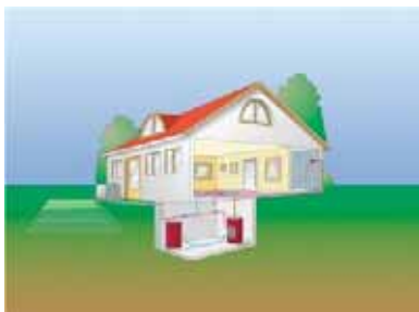
Bild 1: Anlage mit Horizontal-Kollektor (Außen-Aufstellung)
