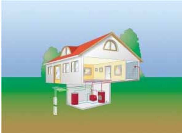
Bild 2: Innen aufgestellte Anlage mit Vertikalkollektor (Erdspieße)
