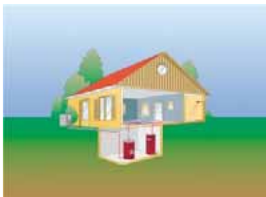
Bild 2: Schema Luft-Wasser-Wärmepumpe in Außenaufstellung
