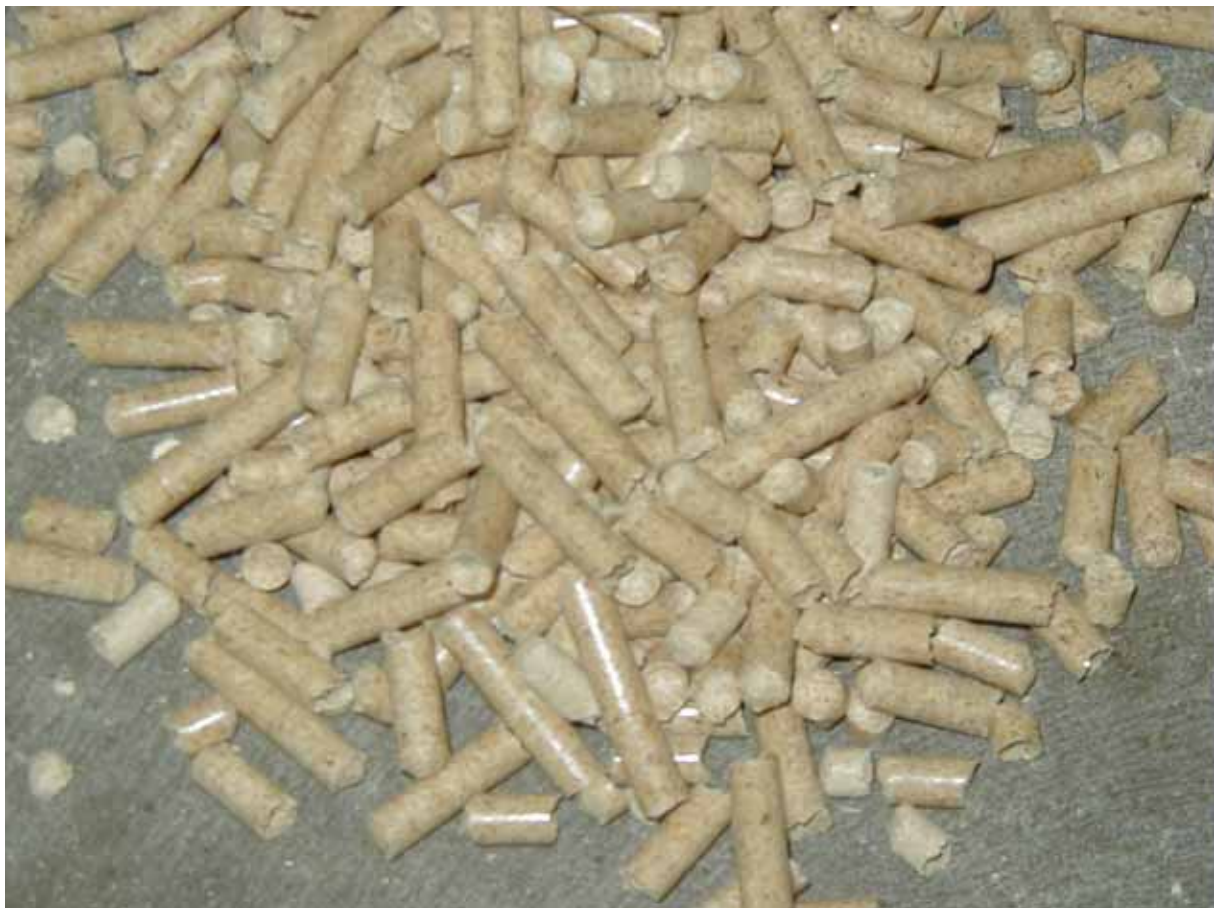
fertige Holzpellets aus der Presse
