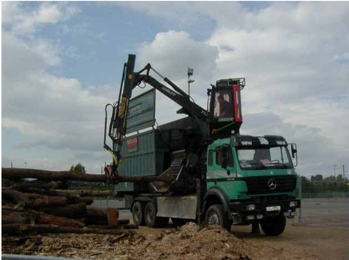
Trommelhacker für 100m 3 Hackschnitzel pro h
